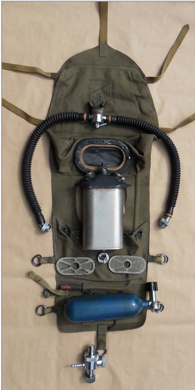
Bilder 17/18: Kreislauf-Tauchgerät Medi-Nixe, demontiert und als Schema Foto: M. Müller [48]
