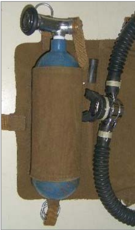
Bild 23: O 2 -Flasche in einer Stoffschlaufe
