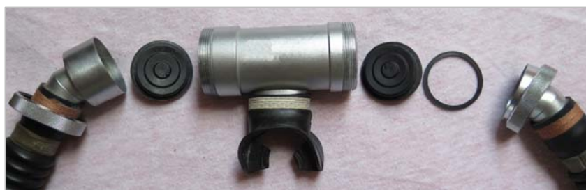
Bild 60: Demontiertes neues Mundstück
