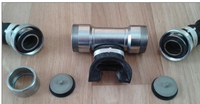
Bild 58: Demontiertes Standard-Mundstück mit den Richtungsventilen
