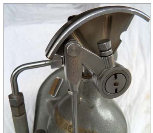
Bild 64/65: Reserveventil mit Anschluss für Hochdruckmanometer (1. Ausf.)
