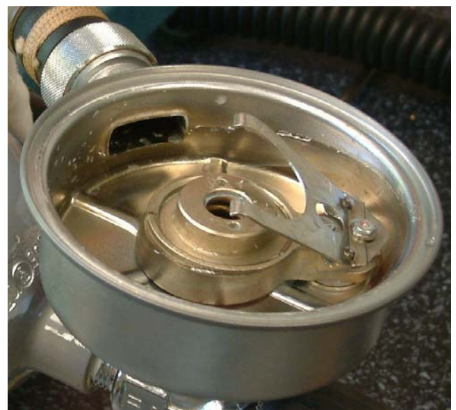
Bild 55: Hydromat v3 mit verdrehter 2. Stufe
