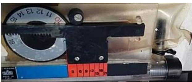
Bild 11: Der interne Mechanismus des DCR
