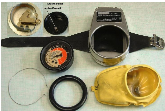
Bild 02: Der DCP und seine Bestandteile
