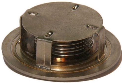
Bild 06: Glimmerventil nach einigen Jahren im Einsatz Die Glimmerscheibe ist mit einem Pfeil markiert. Es fällt auf, dass sie fast keinen Belag aufweist im Gegensatz zu den anderen Bauteilen.
