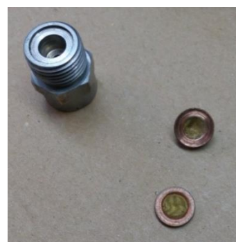
Hochdruckeinlass Filter alt neu hinten
