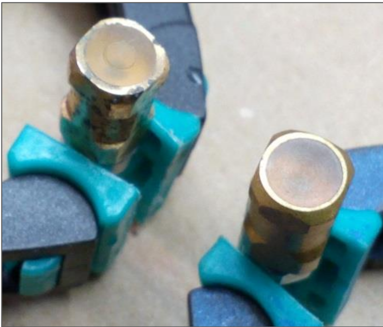
Hochdruckventilstempel alt neu Länge
