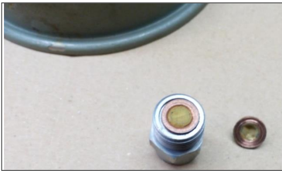
Hochdruckeinlass Filter neu eingesetzt
