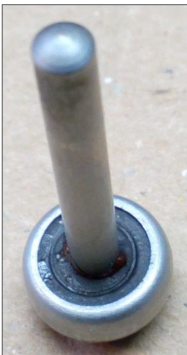
Niederdruckventil mit Verschleiß
