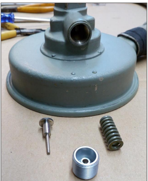
Niederdruckeinstellmechanismus ausgebaut und zerlegt
