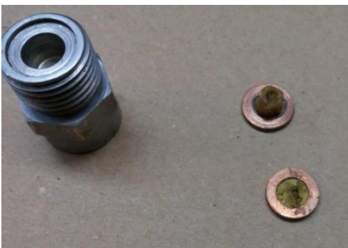
Hochdruckeinlass Filter alt neu vorn
