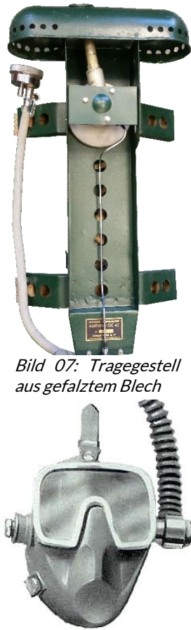
Bild 05: Vollgesichtsmaske (VGM) mit einstellbarem Ausatemventil
