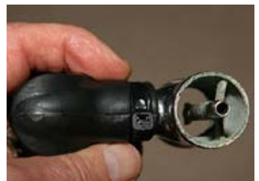
DX-Overpressure mit dem Injektor im Mundstück, Ex-Darstellung unter t1p.de/24u2
