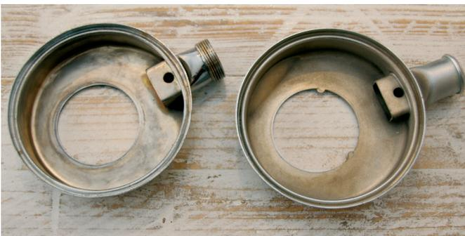
Der Aqua-Lung-Reglerkörper hat zwei halbkreisförmige Ausschnitte, die in das Gewinde gefräst sind und den beiden Vorsprüngen im Gehäuse des Reglers entsprechen, was jede Möglichkeit der Drehung verhindert und den Körper korrekt in Bezug auf den Hufeisenhebel und den Einatemstutzen positioniert.
