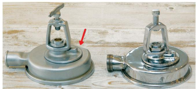
Ein weiterer, eher unwahrscheinlicher Grund für diese Schräge könnte der Versuch sein, einen turbulenten Luftstrom im Reglergehäuse zu erzeugen, der die Leistung erhöht, da die aus dem Ventil der zweiten Stufe austretende Luft auf die 45°-Schräge trifft, was den Luftstrom umkehrt. Dies ist nur eine Annahme und ich habe keine relevanten Studien dazu gefunden.
