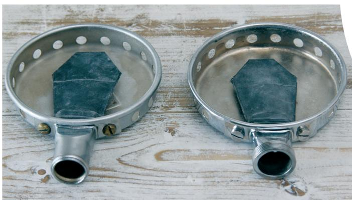
Äußerlich sind die beiden Regler sehr ähnlich mit dem abnehmbaren Ausatemstutzen, den C-Clips zum Zusammenhalten der beiden Schalen, leichtem Unterschied beim Chrom (glänzend vs. matt) und der Bügelschraube. Der Aqua-Lung benötigt aber keinen Schlüssel mehr, um ihn auf dem Flaschenventil zu befestigen, wie der CG45.
