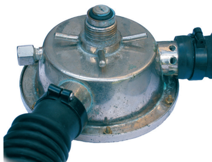
Die gedrückte Unterschale der Serienausführung mit der Schraubverbindung für ein HD-Manometer.
