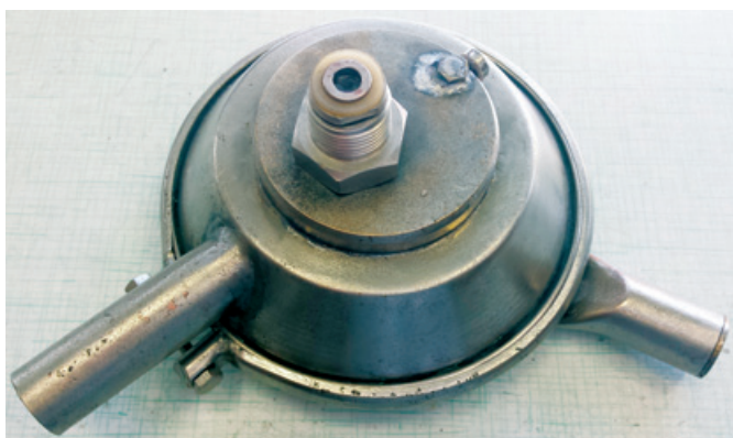
Hebelwerk der zweiten Stufe
