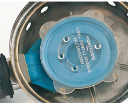
Ausatemventil des Mistral SpiroSub an einem durchsichtigen Gehäuse
