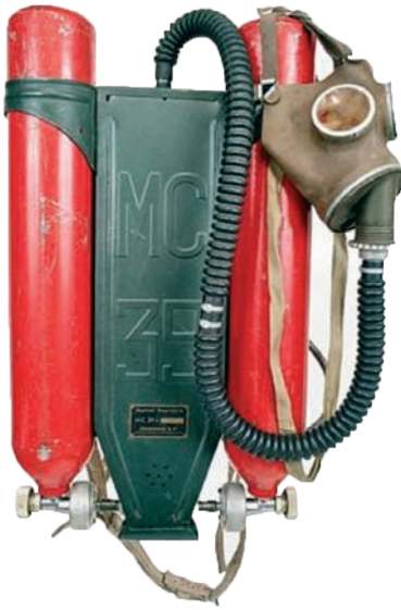
Zusammen mit Mandet entwickeltes Atemgerät MC39 [P03 & P04]
