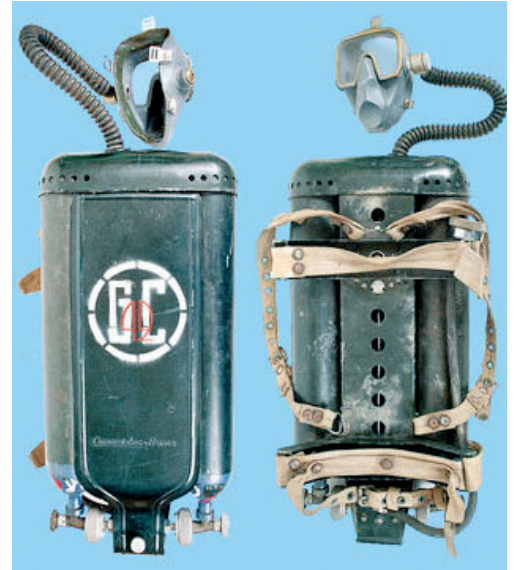
Das Gerät GC42 mit zwei 4- oder 5-l-Flaschen und Vollgesichtsmaske
