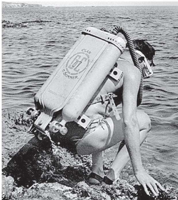
GC47 mit Zweischlauchregler im Einsatz
