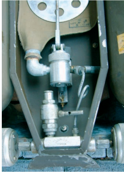
Zusammen mit Mandet entwickeltes Atemgerät MC39 [P03 & P04]
