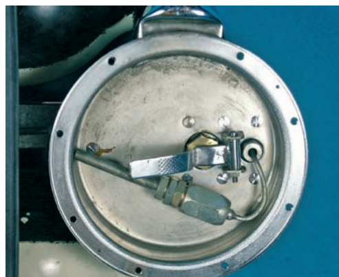
Einstufiger Regler des C58 mit akustischer Warn-einrichtung
