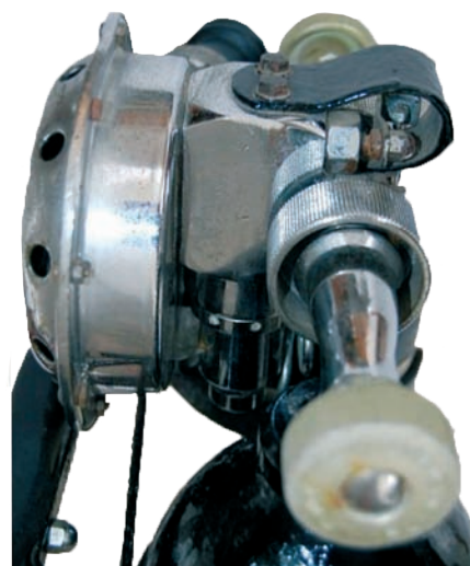
Seitenansicht des C58-Reglers, ev. zweistufig mit einer ersten Stufe hinter der Reglerdose
