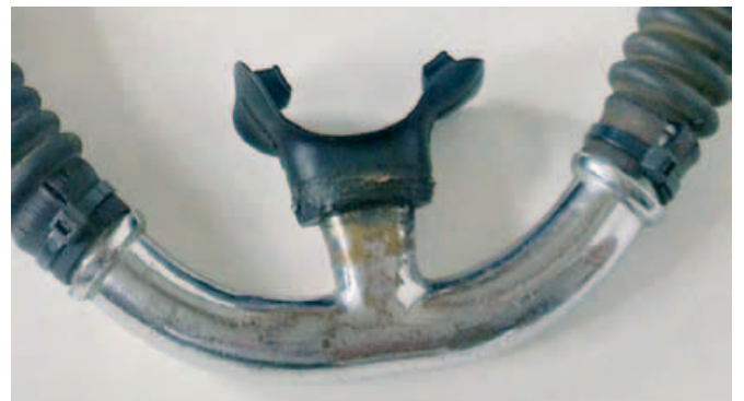
Aus dem Le-Prieur-Mundstück entwickeltes Zweischlauch-Mundstück der ersten CG45
