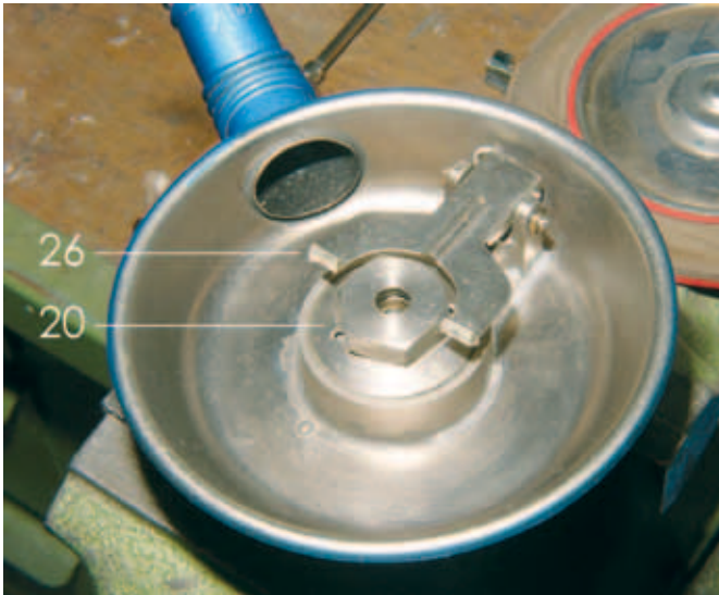
Geöffnetes Automatengehäuse mit Y-förmigem Hebel (26) und der Mutter (20)
