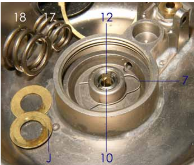
Mitteldruckkammer mit abgenommener Membran. Ganz in der Mitte ist der Druckstift 12 inmitten vom Kraterstück 10 zu sehen. Am Boden der Mitteldruckkammer klemmt die Distanzfeder 7 um das runde Mittelteil. Deren Funktion ist nicht auf den ersten Blick zu erkennen.
