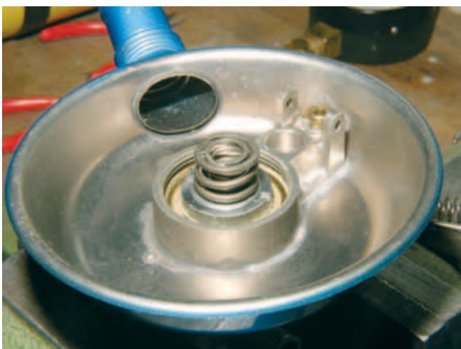
Druckminderer mit abgenommener Mutter (20). Darauf sitzt die Druckfeder (18) sowie eine zweite Feder (17) in deren Mitte. Prinzipiell würde eine Feder reichen, um genügend Gegendruck zum Mitteldruck aufzubauen. Um ein „Hämmern“ der ersten Stufe zu verhindern, werden zwei Federn mit deutlich verschiedenen Schwingungseigenschaften verwendet. So wirken die Federn gegenseitig als Schwingungsdämpfer.
