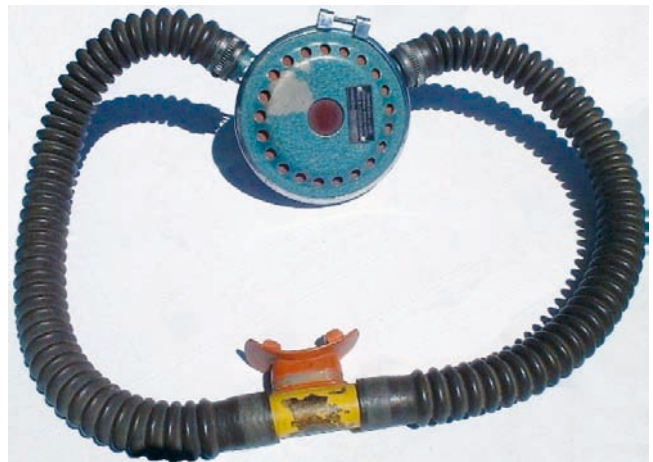
Kompletter einstufiger Regler AV1
