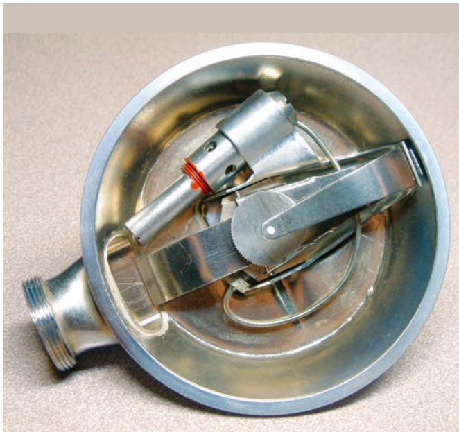
Geöffneter Atemregler Saturn mit Warnpfeife (L. Seveke)
