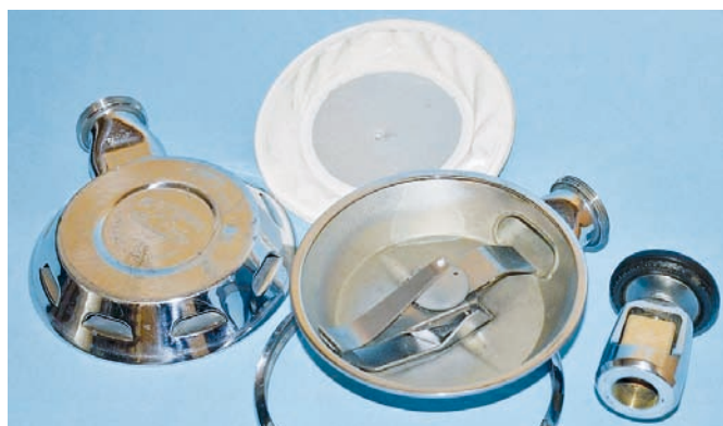
Geöffneter Tauchregler Saturn
