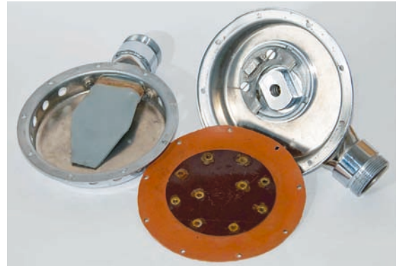
Geöffneter Regler Chirana
