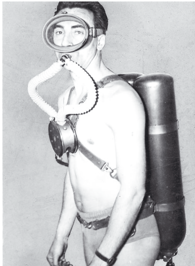
Georges mit einem Doppelflaschen-Rücken-Gerät und seinem Brust-Regler mit doppelter Membran (Archiv Claire Hérail)
