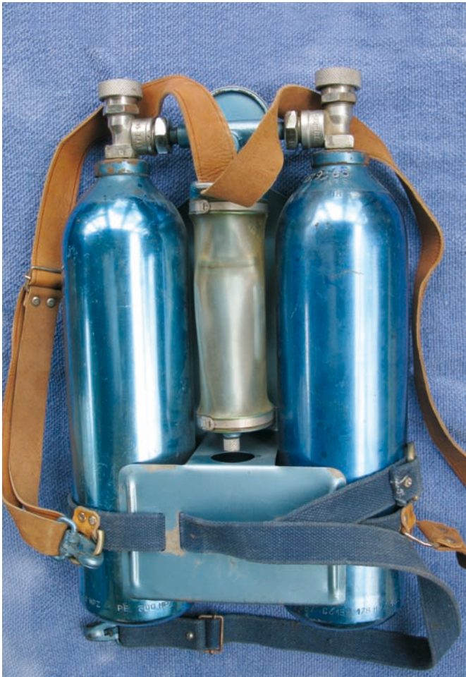
Rückseite der Poumondeau Ventral mit dem Regler in einem zylindrischen durchsichtigen Gehäuse (Foto: Ph. Rousseau)
