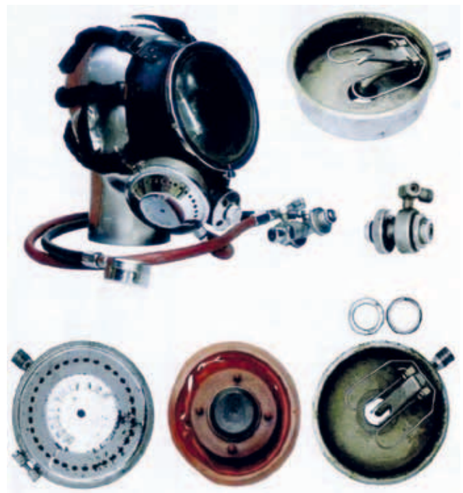
Villy Arps Automat für eine Vollgesichtsmaske
