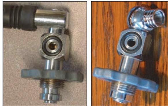
Bild 140: Manometerabgang am DIN-INT-Anschluss
