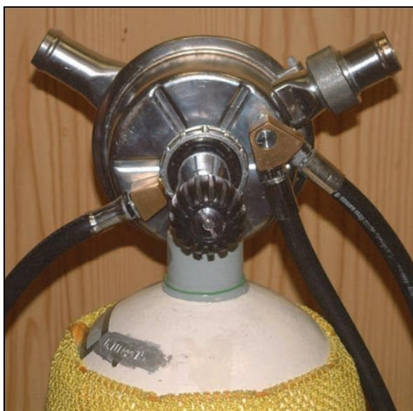
Bild 147: Kompaktregler Hydromat mit HD-Abgang und zwei MD-Abgängen
