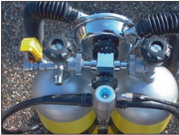
Bild 138: Brücke mit versetzten Regleranschlüssen nach F. Rothbrust
