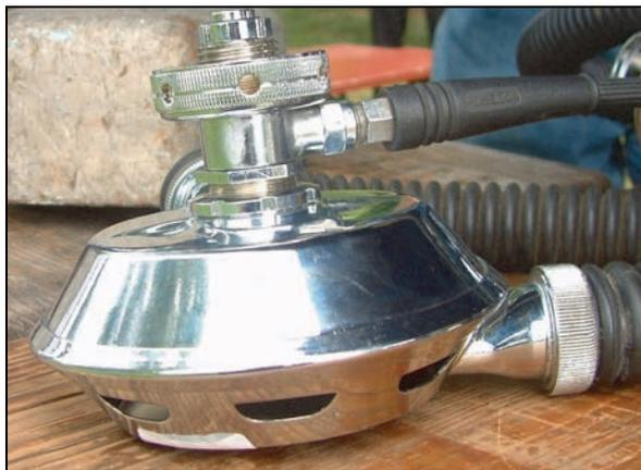
Bild 146: Kompaktregler Saturn mit drehbarem HD-Abgang
