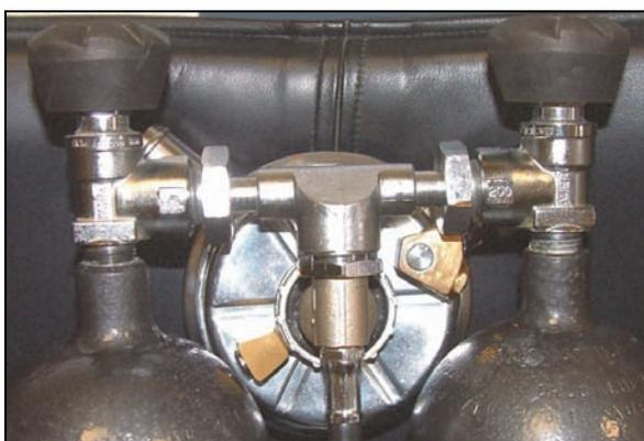
Bild 154: Tiefer gelegter DIN-Regler mit Winkelstück und Manometer-Port
