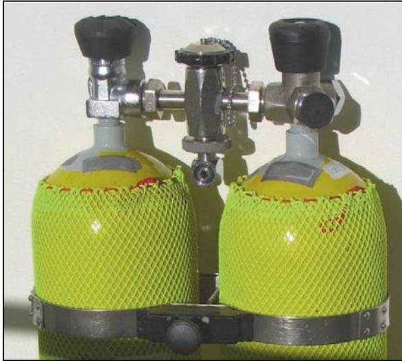
Bild 152: Hängender DIN-INT-Adapter an der Brücke eines Doppelpaketes
