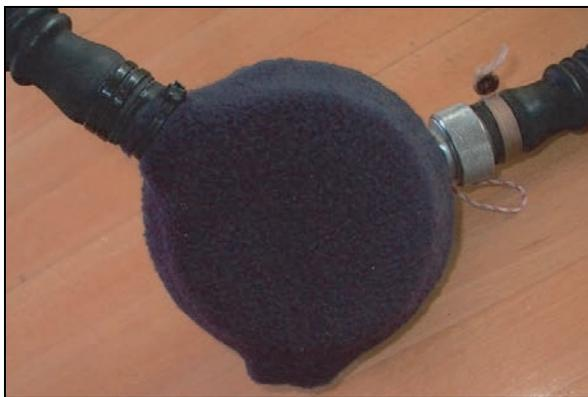
Bild 159: Schalldämpfer aus Vlies (nach F. Rothbrust)
