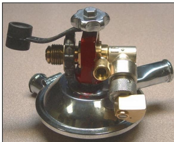
Bild 145: Spezialadapter mit DIN-Anschluss, HD-Port, Miniregler und zwei MD-Abgängen
