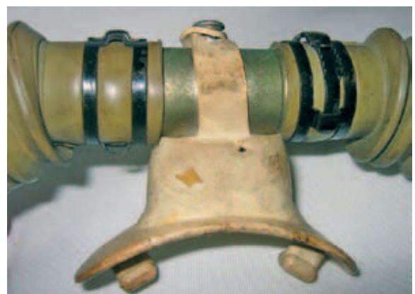
DivAir-Mundstück mit Schnellwechsel-Bissstück von Healthways
