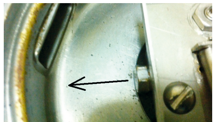
Inneres des DX StreamAir mit schräg angesetztem Injektorrohr (Russ, VDH)
