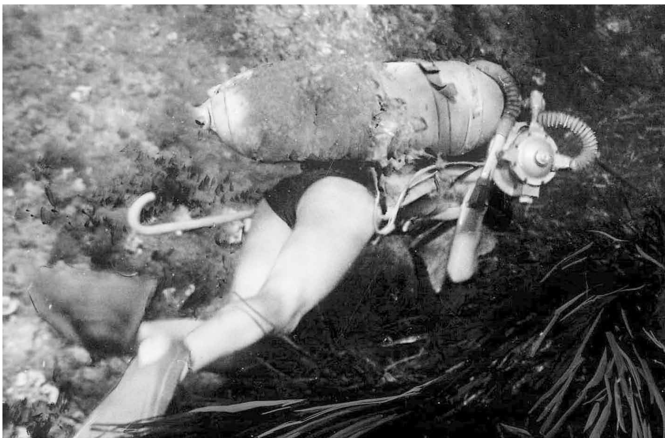
Tauchgerät von Pierre Labat auf Basis eines industriellen Gasreglers
